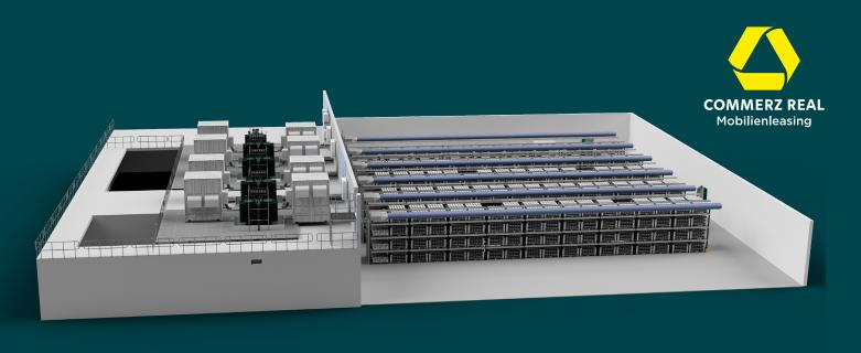
Visualisierung des Stationärspeichers mit Wechselrichtern und Generatoren (links) sowie den Batteriemodulen (rechts).
